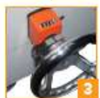
3 アナログカウンターで シワ幅に切替え
